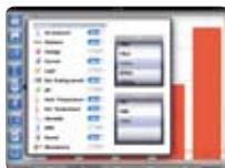
*Manejo del Labdisc: Establece todos los parámetros de almacenamiento de datos, visualización en línea de la mediciones actuales, descarga a la memoria de las muestras del Labdisc.*
